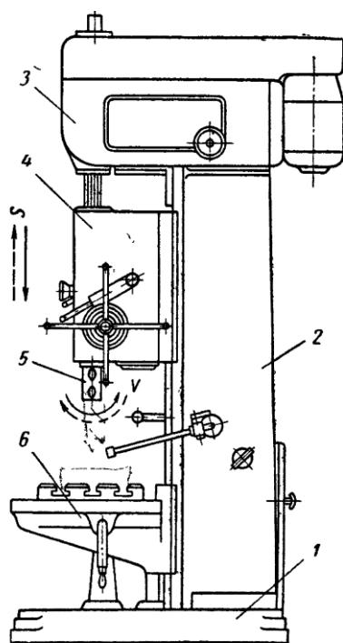
+ вертикально сверлильного станка
