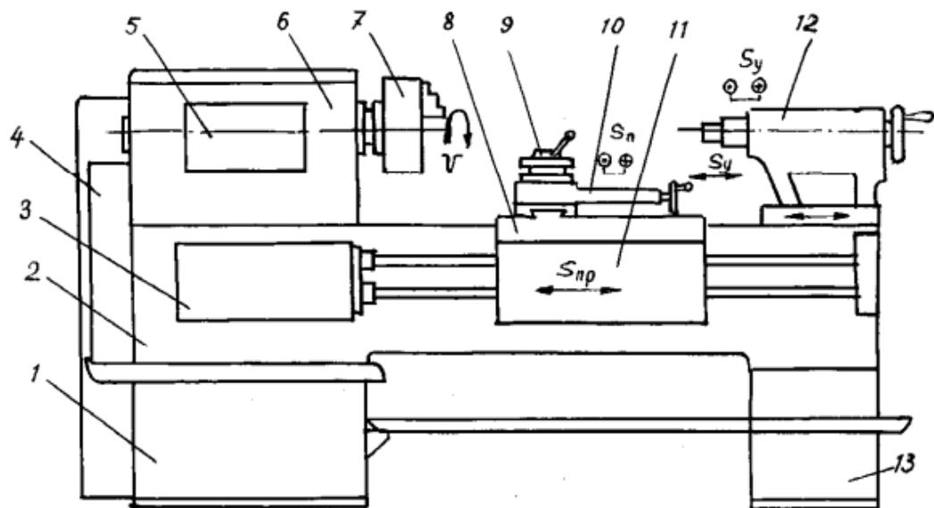
передняя тумба (с электродвигателем главного привода станка);
