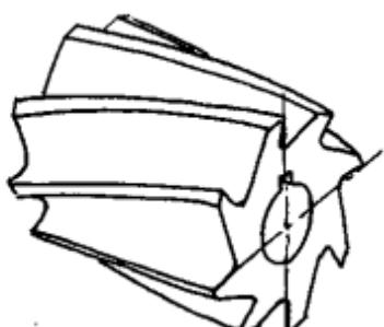
цилиндрическая фреза с прямым зубом;
