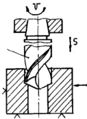
Сверление глухого(сквозного) отверстия спиральным сверлом
