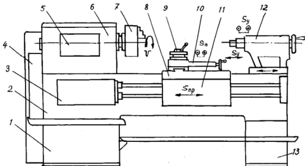
передняя тумба (с электродвигателем главного привода станка);
