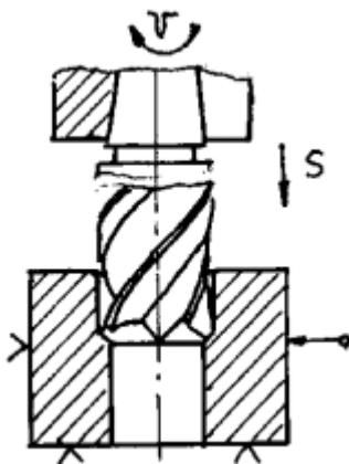
Сверление глухого(сквозного) отверстия спиральным сверлом
