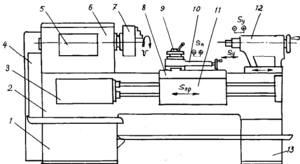
передняя тумба (с электродвигателем главного привода станка);
