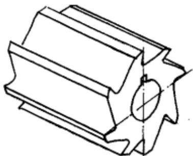
цилиндрическая фреза с прямым зубом;
