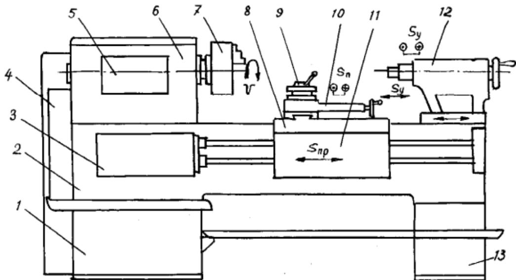
передняя тумба (с электродвигателем главного привода станка);
