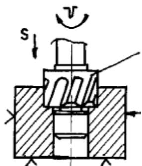
Сверление глухого(сквозного) отверстия спиральным сверлом
