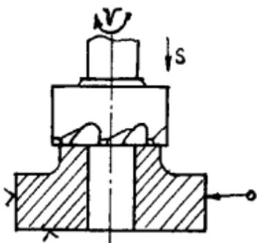
Сверление глухого(сквозного) отверстия спиральным сверлом
