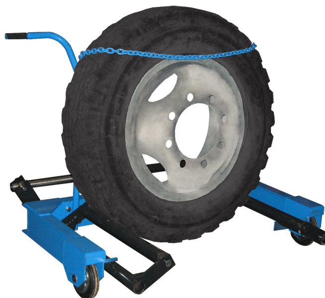
ПРИСПОСОБЛЕНИЕ ДЛЯ СНЯТИЯ КОЛЕС (привод – ручной)
