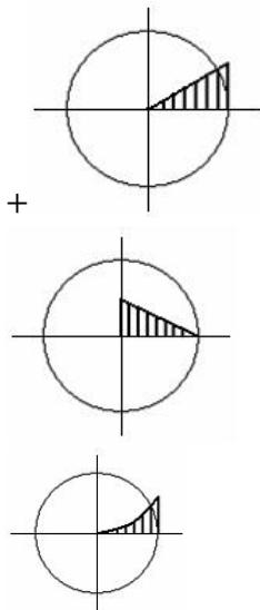
**Стержень скручивается.**      **Максимальные касательные напряжения**
