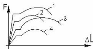
На рисунке показаны диаграммы растяжения четырех образцов из различных пластичных материалов. Наибольшей пластичностью обладает материал образца с диаграммой под номером...
