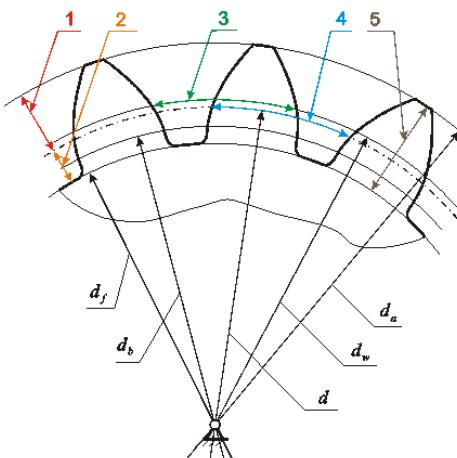
На рисунке изображено прямозубое цилиндрическое эвольвентное зубчатое колесо. Высота зуба обозначена цифрой ...
