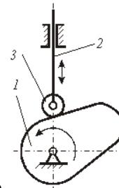
**Механизм, структурная схема которого показана на рисунке**
