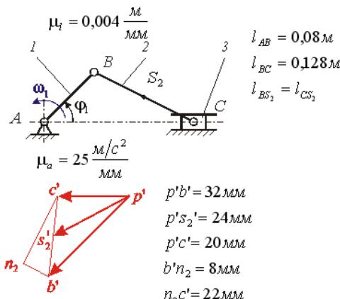
На рисунке показаны план положений и план ускорений кривошипно-ползунного механизма. Ускорение т.  $S_2$  шатуна 2 равно  $m/c^2$ :
