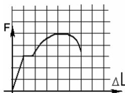
На рисунке показана диаграмма растяжения стального образца диаметром 0,01м. Масштаб нагрузки – 1 деления – 0,007 Мн. Тогда предел текучести материала равен...
