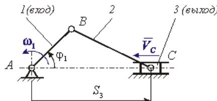
На рисунке приведена кинематическая схема кривошипно-ползунного механизма компрессора. Функция положения этого механизма записывается в виде ...
