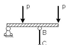
Если стержень BC одинаково работает на растяжение и сжатие , то проверку прочности проводят по условию...
