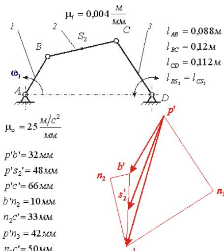
На рисунке показаны план положений и план ускорений шарнирного четырехзвенного механизма. Угловое ускорение шатуна 2 равно  $\text{рад}/\text{с}^2$ :
