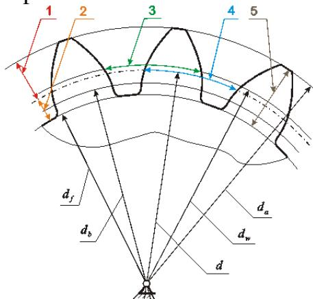
На рисунке изображено прямозубое цилиндрическое эвольвентное зубчатое колесо. Делительный окружной шаг зубьев обозначен цифрой...
