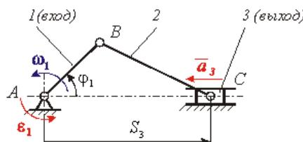
На рисунке приведена кинематическая схема кривошипно-ползунного механизма компрессора. Ускорение выходного звена – ползуна 3 определяется зависимостью ...
