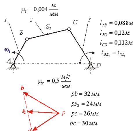
На рисунке показаны план положений и план скоростей шарнирного четырехзвенного механизма. Угловая скорость шатуна 2 равна рад/с:
