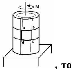
Если к тонкостенной трубе приложен скручивающий момент  $M$ , то напряженным состоянием для элементарного объема «abcd» будет...
