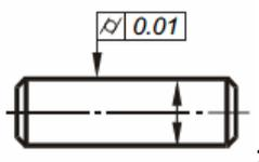
+ допуск и отклонение от цилиндричности
