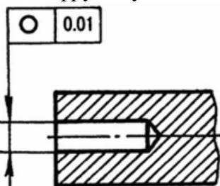
допуск цилиндричности отверстия равен 0,01 мм.
