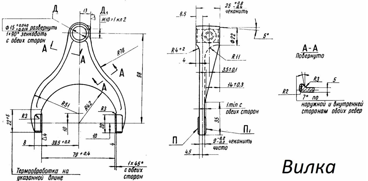
Рис. 2. Пример чертежа детали, полученной штамповкой
