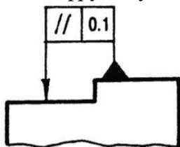
+ допуск параллельности поверхностей равен 0,1 мм.
