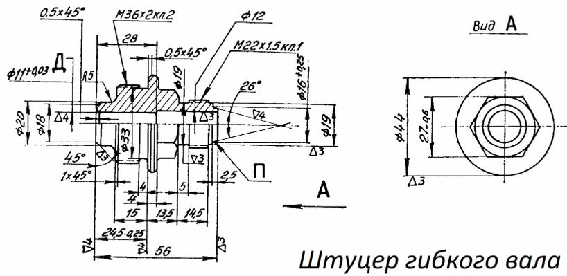
Рис. 3. Пример чертежа детали, полученной из проката
