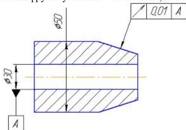
допуск торцевого биения конической поверхности 0,01 мм относительно оси отверстия  $\text{Ø } 30$  мм
