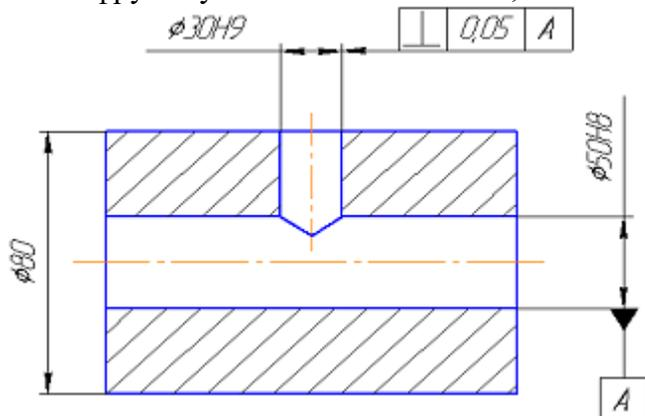
+ допуск перпендикулярности оси отверстия  $\varnothing 30H9$  относительно оси отверстия  $\varnothing 50H8$  равен 0,05 мм
