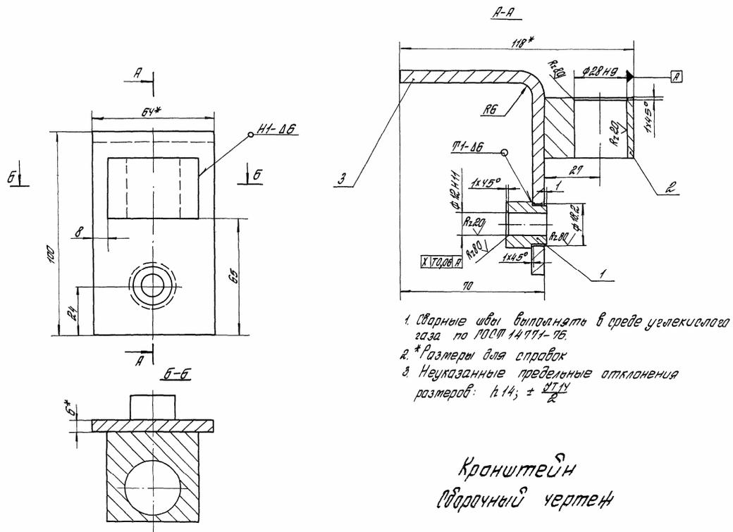
Рис. 4. Пример чертежа сборочной единицы, полученной сваркой
