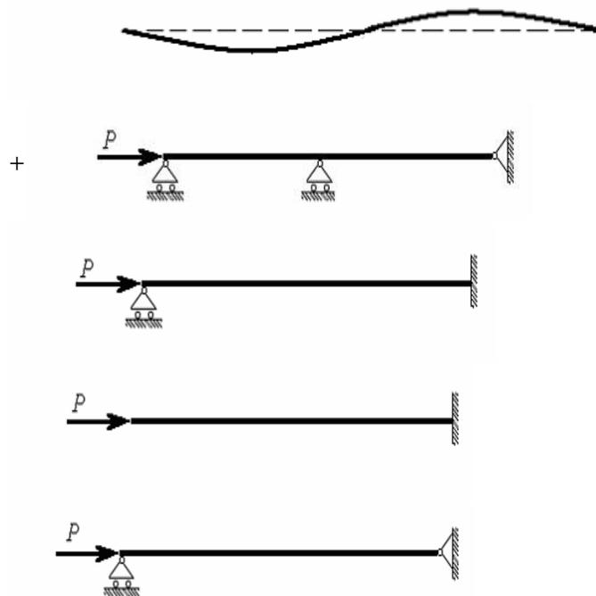
Для показанного на рисунке способа закрепления стержня коэффициент приведенной длины  $\mu$  при вычислении критической силы по формуле Эйлера при потере устойчивости равен :
