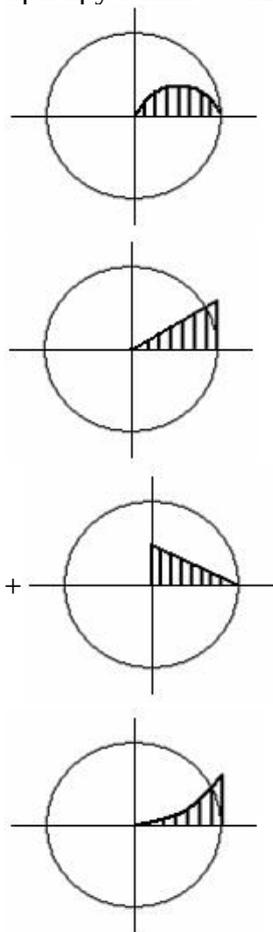
Стержень скручивается. Максимальные касательные напряжения действуют:
