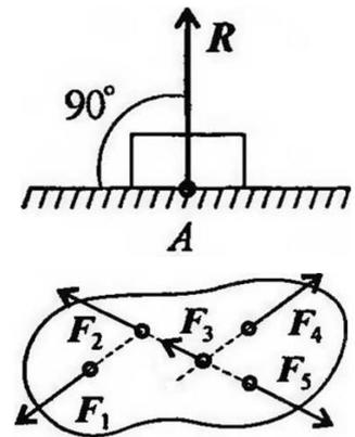
При условии, что  $F_1 = - |F_4|$ ,  $F_2 = - |F_5|$ ,  $F_3 \neq - |F_5|$ , эти силы системы можно убрать, не нарушая механического состояния тела:
