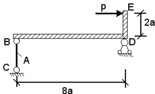
Нормальные напряжения  $\sigma$ , действующие в сечении стержня BC, равны:
