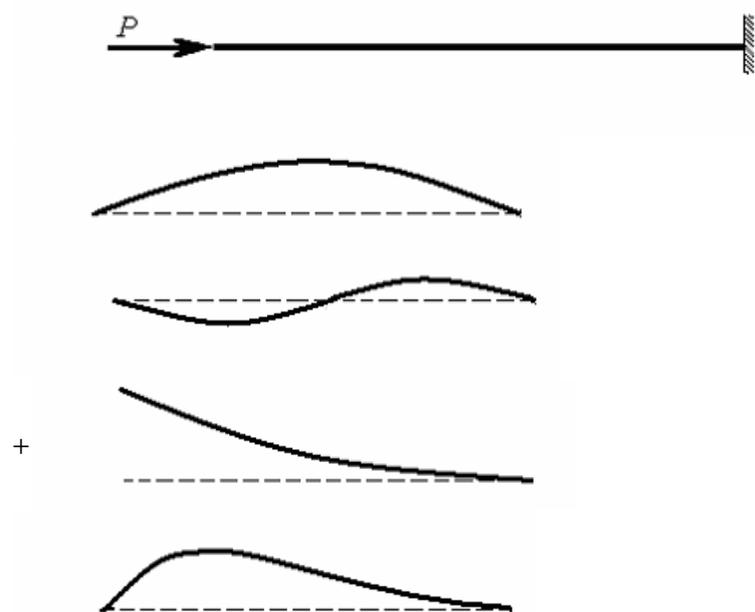
Приведенная на рисунке форма потери устойчивости сжатого стержня соответствует способу закрепления стержня, показанному на схеме :
