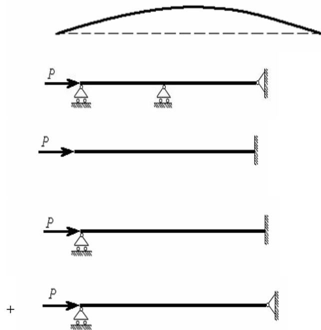
Приведенная на рисунке форма потери устойчивости сжатого стержня соответствует способу закрепления стержня, показанному на схеме :
