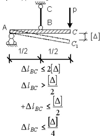
Если стержень ВС одинаково работает на растяжение и сжатие, то проверку прочности проводят по условию:
