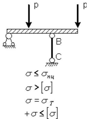
Абсолютно жесткий элемент BD закреплен в точке D неподвижным шарниром, а в точке B упругим стержнем BC с площадью поперечного сечения A.
