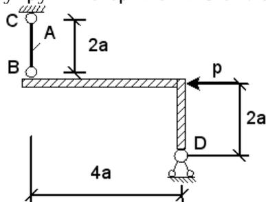
Нормальные напряжения  $\sigma$ , действующие в сечении стержня BC, равны:
