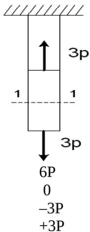
Для стержня, схема которого изображена на рисунке, нормальное усилие  $N$  в сечении 1-1 будет равно:
