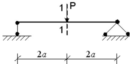
в сечении 1-1 модуль изгибающего момента  $|M|$  и модуль поперечной силы  $|Q|$  при изгибе соответственно равны:
