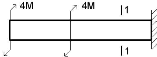
модуль крутящего момента  $|M_{кр}|$ , действующего в сечении 1-1 равен:
