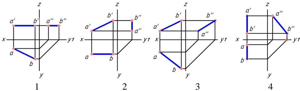
*Правильный ответ:* прямая АВ параллельна фронтальной плоскости проекций на рисунке 2, так как ее горизонтальная проекция параллельна оси Х, а фронтальная проекция наклонена к оси Х.
