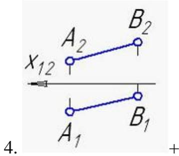
**16. Отрезок АВ, имеющий натуральную длину на комплексном чертеже, изображен на рисунке...**
