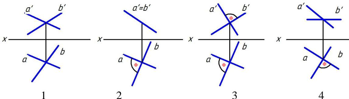
*Правильный ответ:* прямые перпендикулярны на рисунке 4, так как одна из прямых параллельна горизонтальной плоскости проекций.
