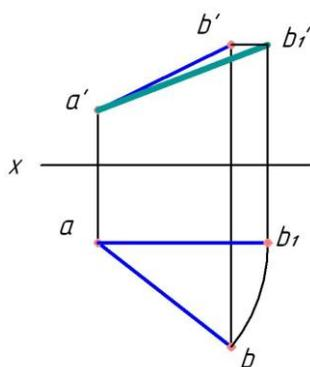
На данном рисунке отрезка  $AB$  найдена способом \_\_\_\_\_ натуральная величина отрезка
