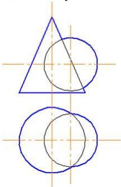
*Правильный ответ:* в данном случае рационально использовать способ секущих плоскостей. Направление секущих плоскостей параллельное горизонтальной плоскости проекций. Такие плоскости пересекут данные поверхности по простым линиям – окружностям.
