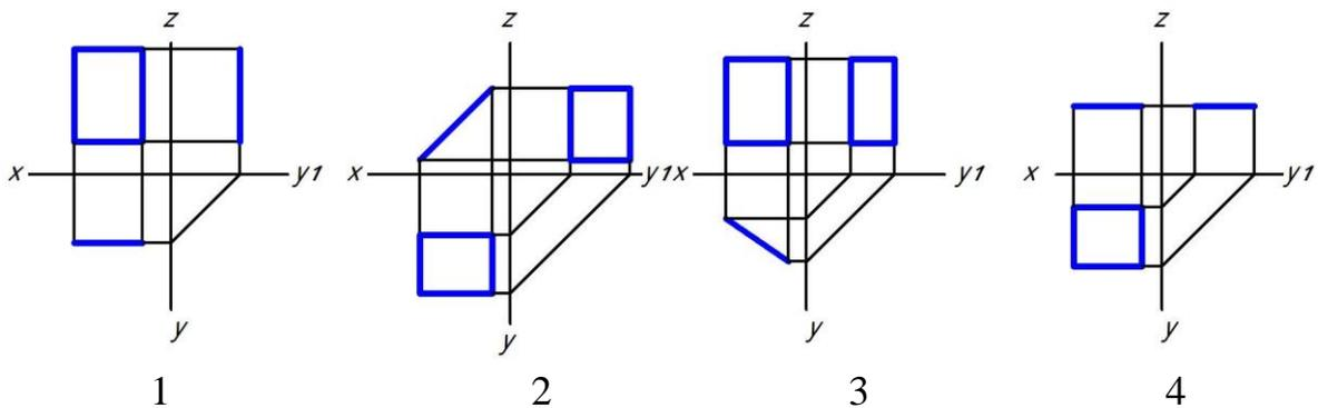
*Правильный ответ:* прямоугольник перпендикулярен только горизонтальной плоскости проекций на рисунке 3, так как его горизонтальная проекция представляет собой отрезок, наклоненный к оси Х.
