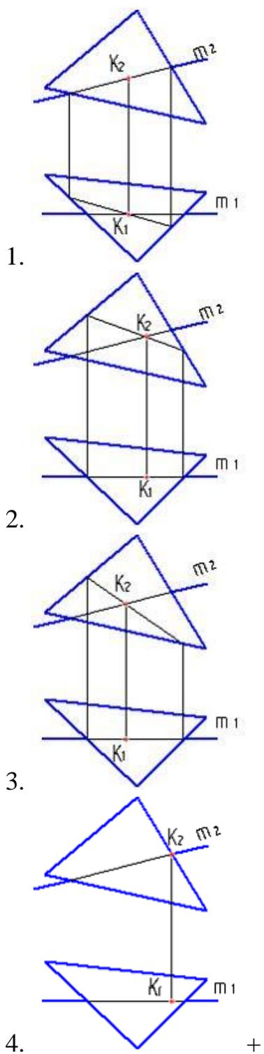
**24. Укажите рисунок, на котором правильно определена точка  $K$  – пересечения прямой  $m$  с плоскостью треугольника  $ABC$ .**
