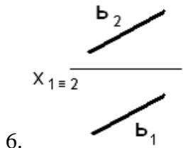
**3. Прямые, параллельные профильной плоскости проекций, показаны на чертежах...**
