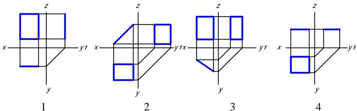
*Правильный ответ:* прямоугольник перпендикулярен только фронтальной плоскости проекций на рисунке 2, так как его фронтальная проекция представляет собой отрезок, наклоненный к оси Х.
