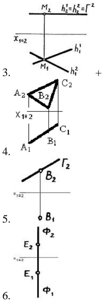
**6. Плоскости, параллельные фронтальной плоскости проекций, показаны на чертежах...**
