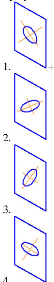
**17. Эллипс 1, изображенный в прямоугольной изометрии и показанный на рисунке, имеет размер малой оси, равный \_\_\_, (где d – величина диаметра окружности в пространстве).**
