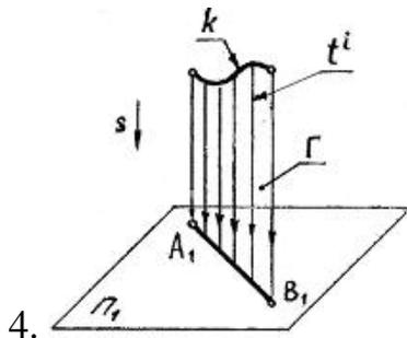
5. Параллельное косоугольное проецирование показано на чертеже...
