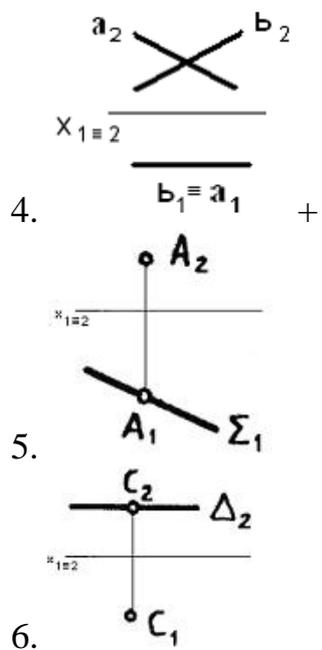
**7. Плоскости, параллельные профильной плоскости проекций, заданы на чертежах...**
