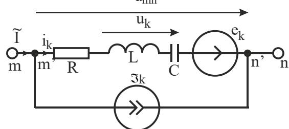
проходящего по проводникам ветви « $k$ » от узла « $m$ » к « $n$ », и по внешнему пространству, будет записано в виде:
