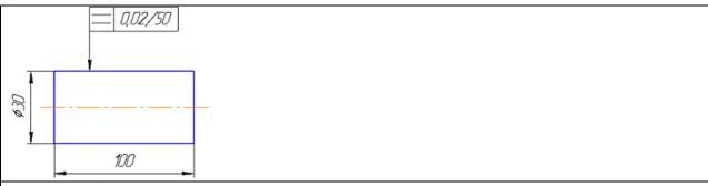
отклонение формы от цилиндричности не должно превышать 0,02 мм на длине 50 мм +отклонение профиля продольного сечения не должно превышать 0,02 мм на любом участке поверхности длиной 50 мм
