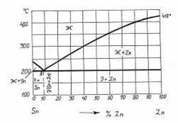
механическая смесь кристаллов Zn и Sn + жидкая фаза и кристаллы Zn жидкая фаза и кристаллы Sn жидкая фаза
