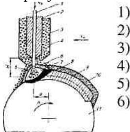
+дуговой наплавки под слоем флюса
