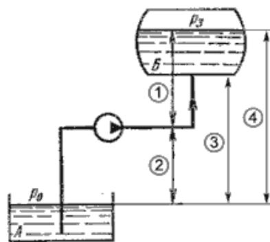
Геометрическая высота нагнетания на рисунке обозначена позицией:
