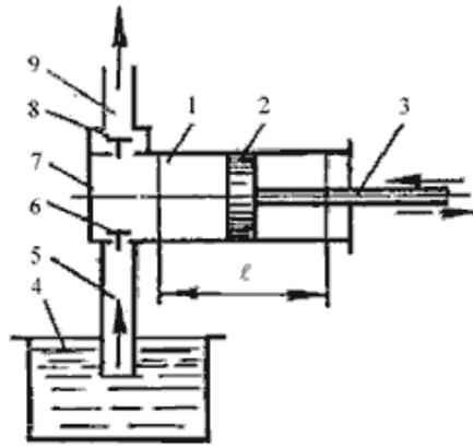
На рисунке изображен поршневой насос простого действия.
