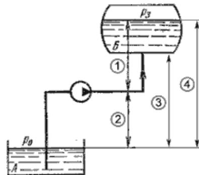
Геометрическая высота нагнетания на рисунке позицией:
