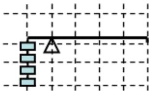
**На рисунке изображён рычаг, к короткому плечу которого подвешены четыре одинаковых груза. Сколько нужно подвесить к концу длинного плеча таких же грузов?**
