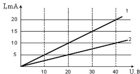
Отношение сопротивлений  $R_1/R_2$  этих элементов равно...
