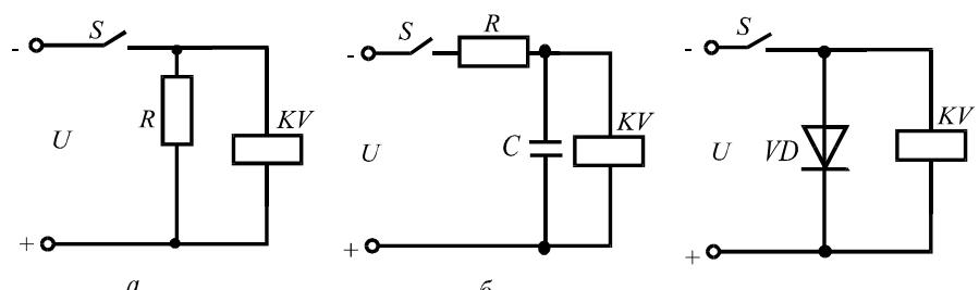
**Какая из предложенных схем создаст замедление срабатывания реле?**
