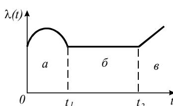
На графической зависимости опасности отказов  $\lambda(t)$  укажите этап приработки:
