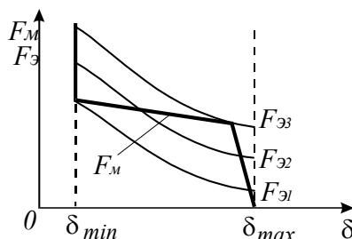
На рисунке показаны семейство тяговых  $F\mathcal{E}=f(d)$  и механическая  $FM = f(d)$  характеристики реле. При какой тяговой характеристике произойдет срабатывание реле?
