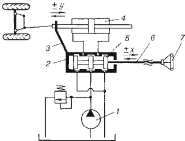
+принципиальная схема следящего рулевого привода автомобиля
