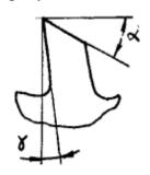
+ трапецевидный зуб; затылованный зуб; параболический зуб; эвольвентный
