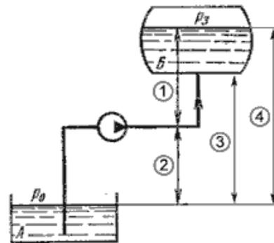
Геометрическая высота нагнетания на рисунке позицией:
