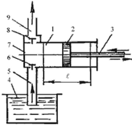
**На рисунке изображен поршневой насос простого действия. Укажите правильное обозначение его элементов**
