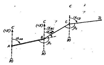
**Решение:** Дирекционные углы вычисляют по правилу: дирекционный угол последующей стороны равен дирекционному углу предыдущей стороны плюс 180° и минус горизонтальный угол, справа по ходу лежащий. Следовательно.
