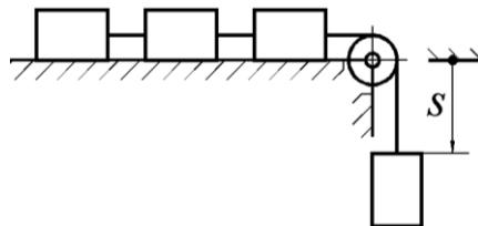
Четыре груза массой  $m = 1\text{ кг}$  каждый, соединенные гибкой нитью, переброшенной через неподвижный невесомый блок, движутся согласно закону  $s = 1,5t^2$ . Определить кинетическую энергию системы грузов в момент времени  $t = 2\text{ с}$ .
