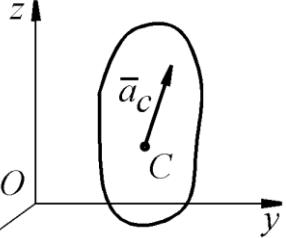
Механическая система движется так, что проекции ускорения ее центра масс С на оси координат равны  $a_{Cx} = \sqrt{3} \text{ м/с}^2$ ,  $a_{Cy} = 2 \text{ м/с}^2$ ,  $a_{Cz} = 3 \text{ м/с}^2$ . Определить модуль главного вектора внешних сил, действующих на систему, если масса системы  $m = 10$  кг.
