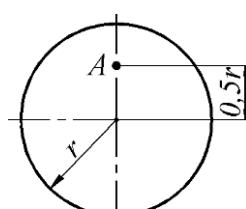
Определить угловую скорость колеса
