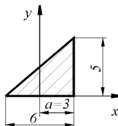
Определить координату  $x_C$  центра тяжести однородной пластины...
