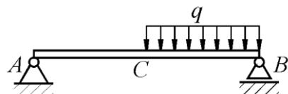
На однородную балку AB вес которой  $G = 20 \text{ kH}$ , действует распределенная нагрузка интенсивностью  $q = 0,5 \text{ kH/m}$ . Определить в кН реакцию опоры A, если длины  $AB = 6 \text{ м}$ ,  $AC = BC$ .
