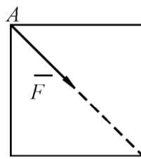
К вершине А квадратной пластины  $B$ , длины сторон которой равны 0,2 м, приложена сила  $F = 150 \text{ H}$ . Определить момент этой силы относительно точки В.
