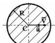
Однородный диск радиуса  $R$  и массы  $m$  катится по горизонтальной плоскости, имея в точке С скорость  $\bar{V}$  и ускорение  $\bar{a}$ . Кинетическая энергия диска равна...
