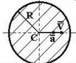
точке С скорость  $\bar{V}$  и ускорение  $\bar{a}$ . Кинетический момент диска относительно оси, перпендикулярной плоскости диска и проходящей через его центр, равен...
