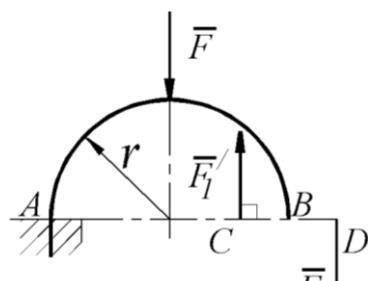
На арку АВ действует пара сил  $(\bar{F}_1, \bar{F}'_1)$  и сила  $\bar{F}$ . Определить сумму их моментов относительно точки А, если силы  $F = 4 \text{ H}$ ,  $F_1 = 2 \text{ H}$ , радиус  $r = 2 \text{ м}$ , плечо  $CD = 1,5 \text{ м}$ :
