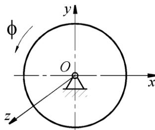
Диск вращается вокруг оси Oz по закону  $\phi = t^3$ . Определить модуль момента пары сил, приложенной к диску, в момент времени  $t = 1 \text{ с}$ , если момент инерции диска относительно оси вращения равен  $2 \text{ кг} \cdot \text{м}^2$ .
