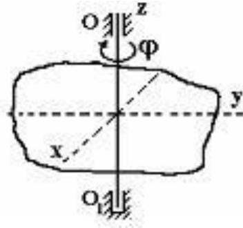
**Твердое тело вращается вокруг неподвижной оси  $O_1O_1$  по закону  $\varphi = 40 - 7t$  ( $\varphi$  – в радианах,  $t$  – в секундах). В промежуток времени от  $t = 0$  до  $t = 1$  с тело вращается...**
