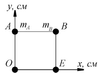
Определить в см координату  $y_C$  центра тяжести квадрата из невесомых стержней с грузами массой  $m_A = 2\text{кг}$ ,  $m_B = 3\text{кг}$ ,  $m_O = 1\text{кг}$ ,  $m_E = 4\text{кг}$ , если  $AO = OE = 30\text{см}$ .
