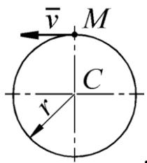
ростью  $v = 4 \text{ м/с}$ . Определить момент количества движения точки относительно центра С окружности радиуса  $r = 0,5 \text{ м}$ .
