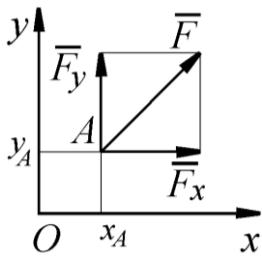
1. Определить момент силы относительно начала координат, если сила задана проекциями  $F_x = F_y = 210 \text{ H}$  и известны координаты точки приложения силы  $x_A = y_A = 0,1 \text{ м}$ :
