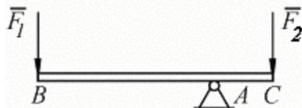
На брусе BC, закрепленный в шарнире A вертикальные силы  $F_1 = 4 \text{ kH}$  и  $F_2$ . Определить силу  $F_2$  в кН, необходимую для того, чтобы брус в положении равновесия был горизонтальным, если расстояния  $AC = 2 \text{ м}$ ,  $AB = 6 \text{ м}$ .
