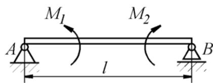
На балку, длина которой  $l = 3 \text{ м}$ , действует пара сил с моментами  $M_1 = 2 \text{ кН} \cdot \text{м}$  и  $M_2 = 8 \text{ кН} \cdot \text{м}$ . Определить в кН модуль реакции опоры В.
